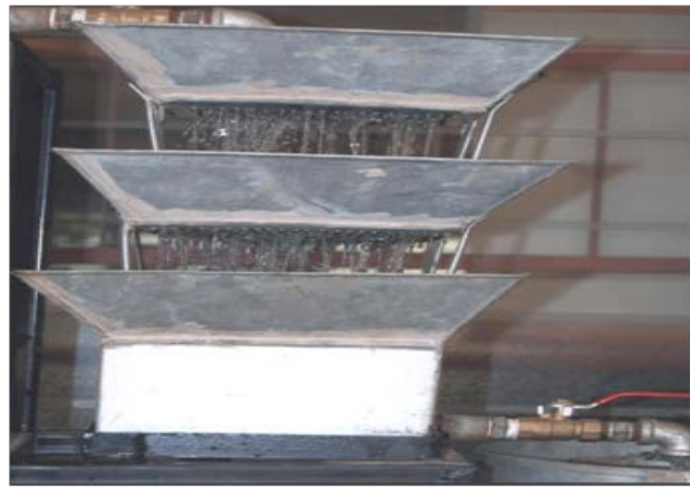
Fig. 2a natural-draft aerator
