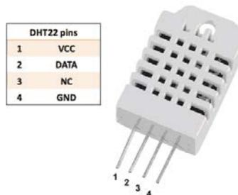
**Figure 2:** Pin structure of DHT22 Sensor
